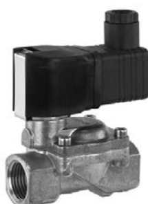
GEMÜ 8258 Électrovanne à commande assistée avec besoin de pression différentielle Laiton ou inox DN 8 - 15 (0,1 - 16 bars)
