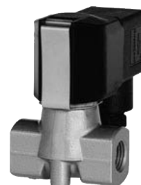
GEMÜ 8259 Électrovanne à commande directe sans besoin de pression différentielle Laiton ou inox DN 1,5 - 5 (0 - 25 bars)
