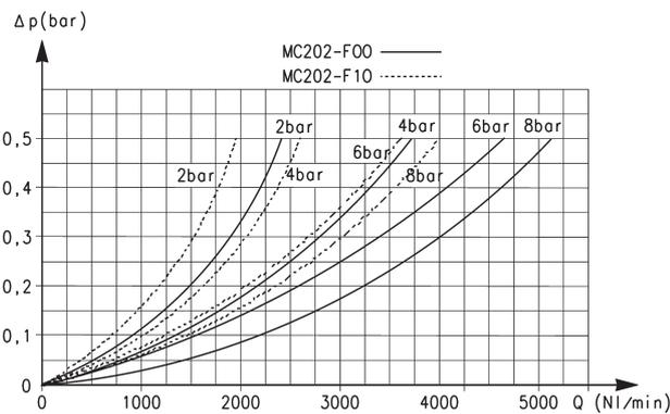
Diagrammes des débits pour les modèles : MC202-F00 et MC202-F10
