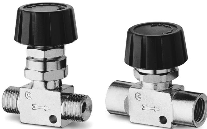
Limiteurs de débit bidirectionnels avec corps en laiton nickelé OT58, joints NBR et bouton de réglage technopolymère. Ils permettent la régulation d'air comprimé, d'eau ou d'huiles minérales. Les limiteurs mod. 2810, 2820, 2819 et 2829 peuvent recevoir du tube plastique, cuivre ou laiton grâce aux écrous mod. 1303, olives mod. 1310 et fourreaux mod. 1320.
